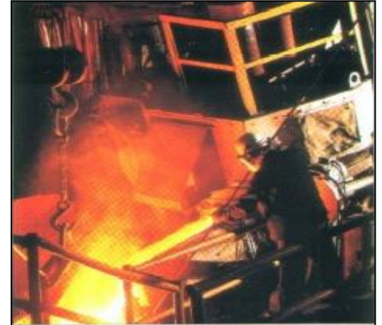
Osmitonová pec na odlévání oceli
